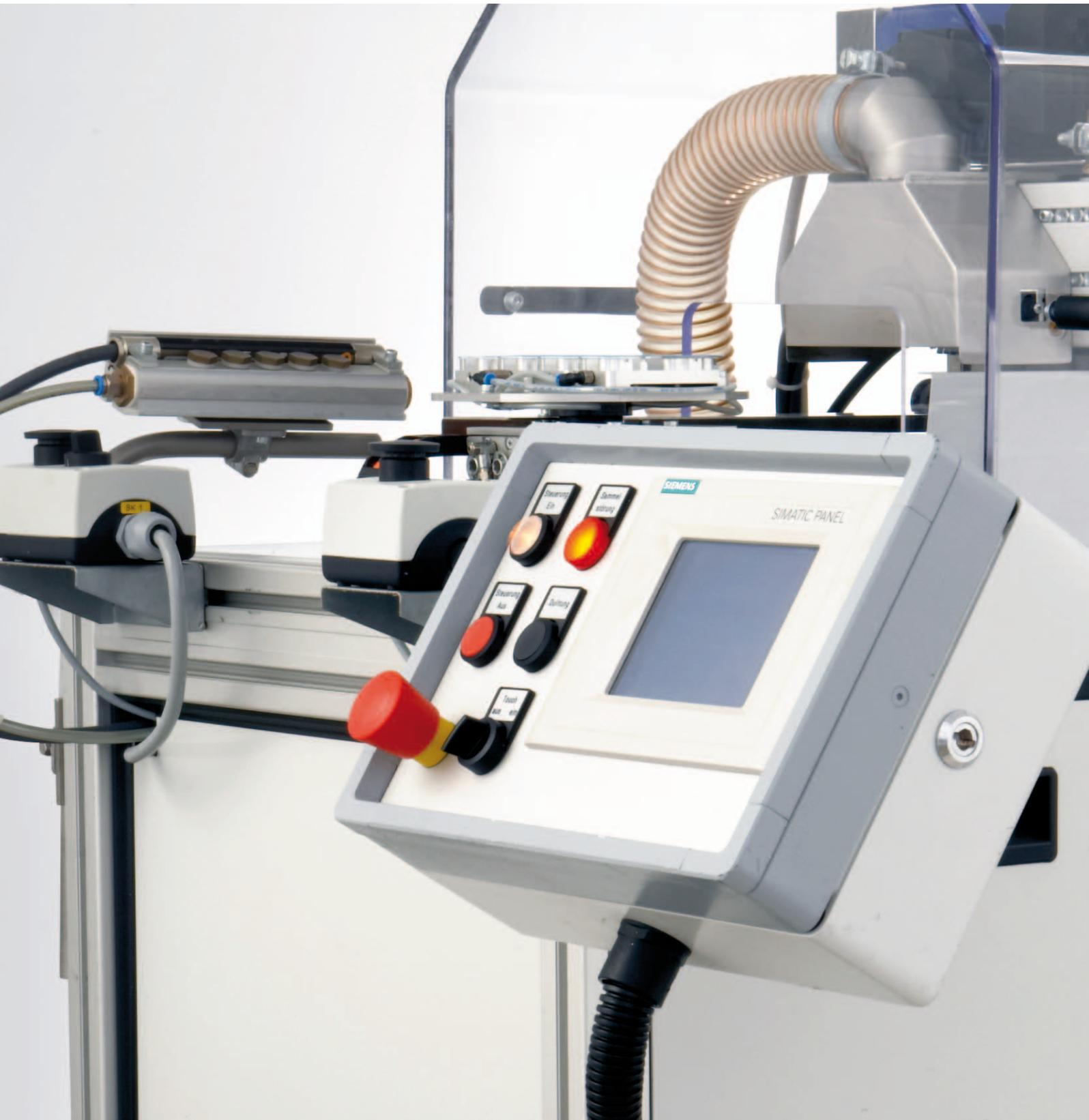
Zur Oberflächenreinigung von flachen oder leicht gewölbten Geometrien bis 200 mm Breite bietet KIST Maschinenbau mit dem CLEANMASTER eine leicht adaptierbare Standardmaschine.
