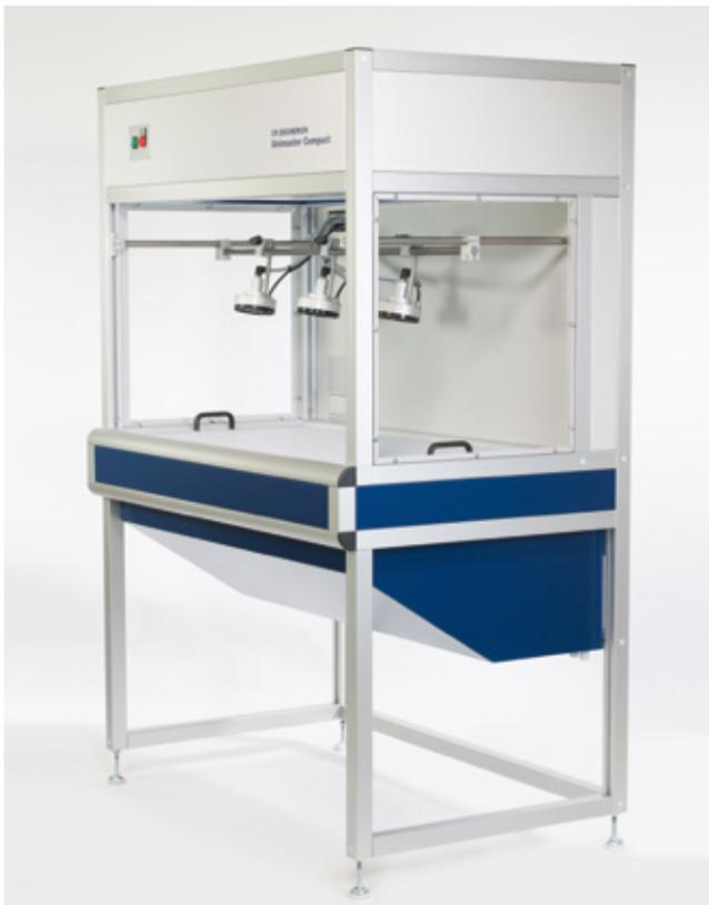
Steharbeitsplatz zur manuellen Reinigung individueller Bauteile verschiedenster Abmessungen vor der Weiterverarbeitung. Frei wählbare, mit Ionisation integrierte Reinigungsköpfe, sorgen für Neutralisation der elektrostatischen Ladungen zwischen Bauteil und Verschmutzung. Pulsierende Luft entfernt lose Partikel. Gelöste Verschmutzung wird mittels laminaren Luftstroms zu einer internen oder externen Absaug- bzw. Filtereinheit geführt. Der UNIMASTER COMPACT ist in drei Abmessungen verfügbar.
